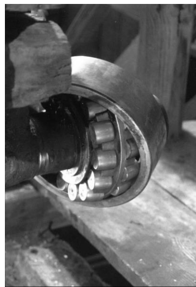
Specjalne łożyska, które podtrzymują „Zygmunta”
